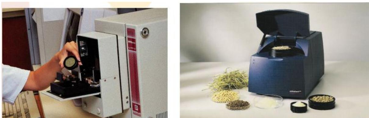
Figura 4. Espectroscópio de refletância no infravermelho próximo (NIRS). Fonte: [www.foss.dk](http://www.foss.dk)
