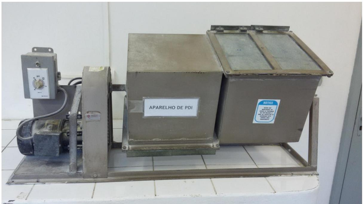
Figura 3. Durabilímetro
