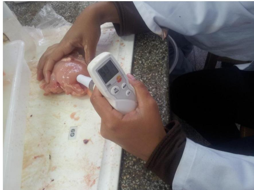
Figura 7. pHmetro de marca Testo, modelo 205. Fonte: O autor (2013).
