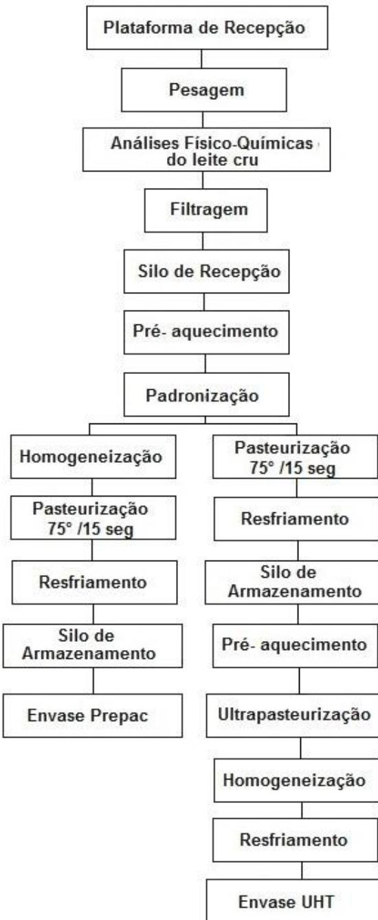
Figura 3. Fluxograma do processo de pasteurização.
