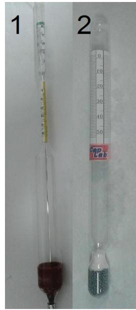
Figura 7. Densímetro (1) e aerômetro de Baumê (2).
