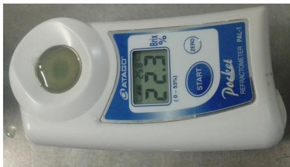
Figura 12. Aparelho refratométrico BRIX.
