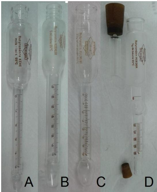
**Figura 8. Tipos de butirômetros.**
