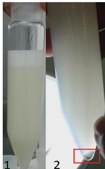
Figura 15. Cone de sedimento.
