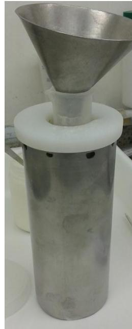
Figura 16. Análise de peso específico.
