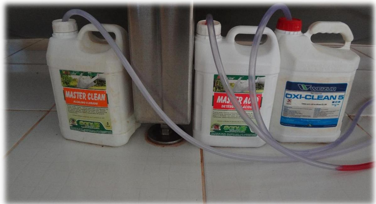
Figura 17: Detergentes para limpeza automática das tubulações.
