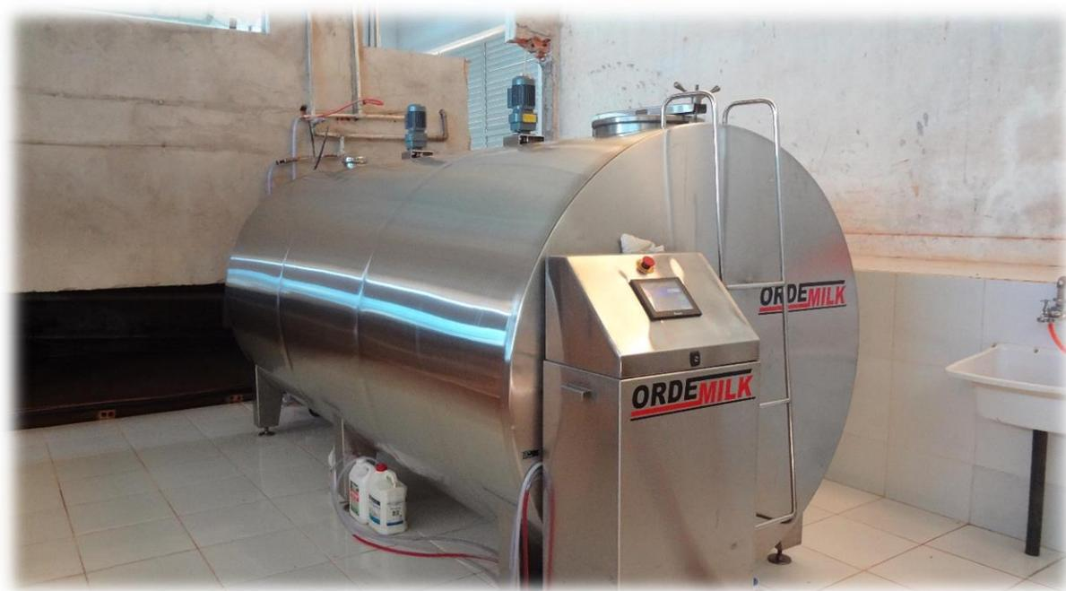
**Figura 15: Tanque resfriador e armazenador.**
