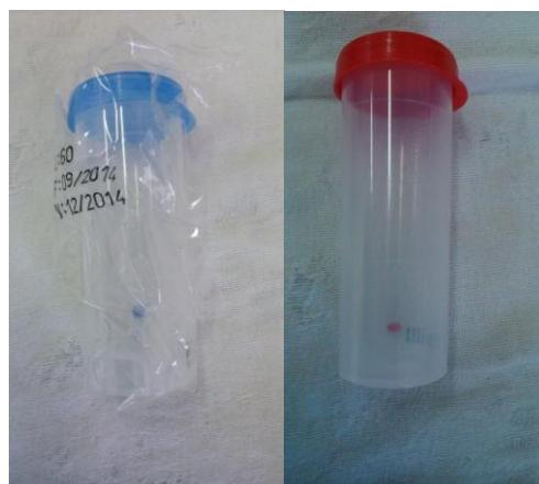
Figura 9- frasco esterilizado com conservante bacteriostático Azidiol para análise de CBT (tampa azul) e frasco com conservante bactericida Bronopol para análise físico- química e CCS (tampa vermelha). Fonte: Arquivo Pessoal
