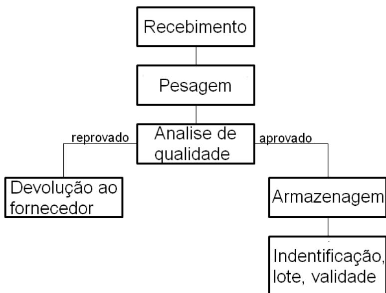
Figura 13. Fluxograma de recepção das matérias-primas - Fonte: (Adaptado de LIMA, 2013).
