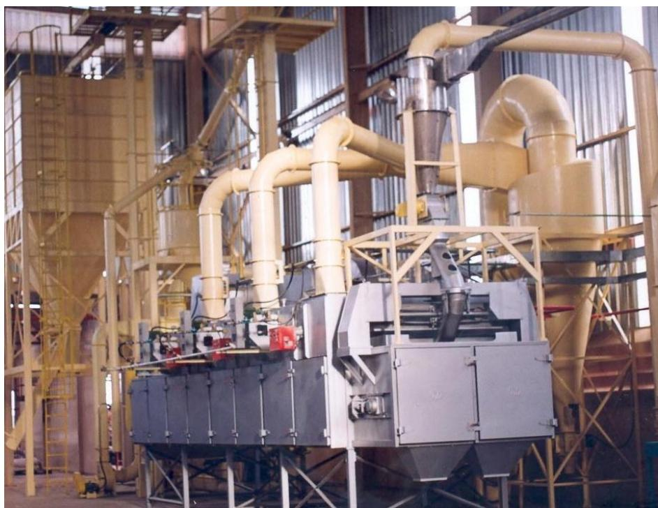
Figura 6. Secador modelo horizontal – Fonte: TECNAL (2014).
