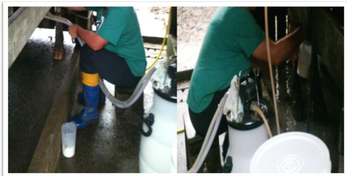
Figura 6 - Aplicação incorreta do teste da caneca de fundo escuro Fonte: o autor (2014)
