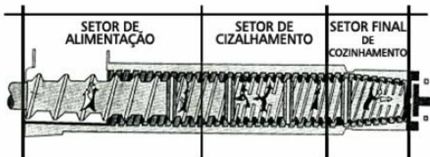
Figura 3 - Setores do canhão extrusor - Fonte: Ferraz (2012)
