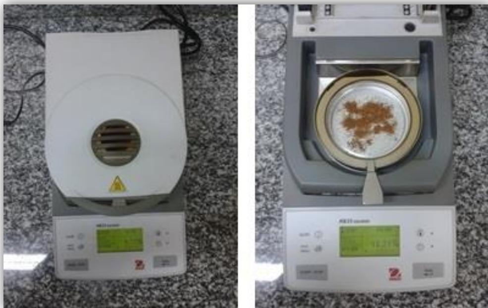
Figura 13 - Aparelho mensurador de umidade.
