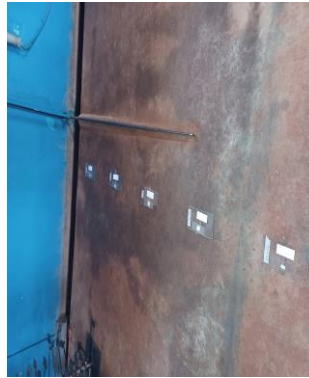
FIGURA 1 – PAPEIS HIDROSENSÍVEIS E MYLACARD POSICIONADOS AO CHÃO PARA DEFINIR DISTÂNCIA DA DERIVA
