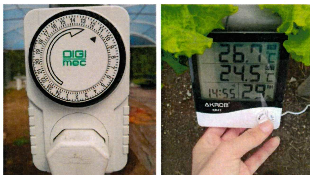
FIGURA 3 – TEMPORIZADOR ANALÓGICO (À ESQUERDA) E HIGRÔMETRO DIGITAL (À DIREITA)
