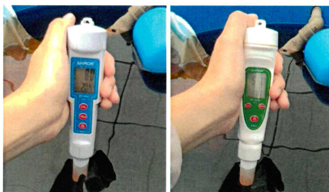
FIGURA 6 – MEDIDOR DE pH (À ESQUERDA) E MEDIDOR DE CONDUTIVIDADE ELÉTRICA (À DIREITA) UTILIZADOS PARA AFERIÇÃO DAS SOLUÇÕES NUTRITIVAS DURANTE O DESENVOLVIMENTO DO EXPERIMENTO
