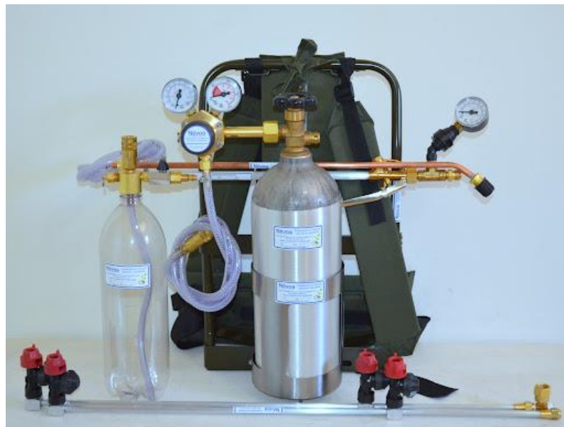
FIGURA 3 – PULVERIZADOR PRESSURIZADO COM CO 2 UTILIZADO PARA APLICAÇÃO DOS TRATAMENTOS
