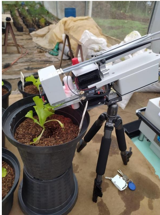
FIGURA 4: ANÁLISE FOTOSSINTÉTICA DAS AMOSTRAS, UTILIZANDO O APARELHO IRGA (Infrared gas analyzer).
