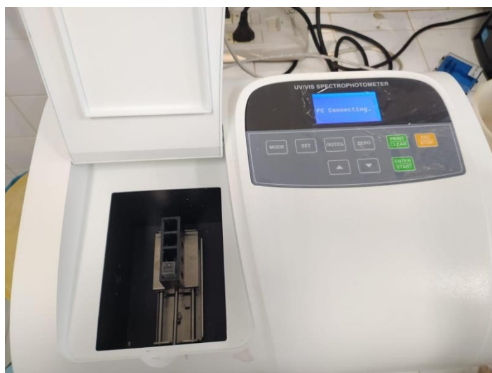
FIGURA 9: ANÁLISE DOS TEORES DE FÓSFORO PELO MÉTODO ESPECTROFOTÓMETRO UVVIS.
