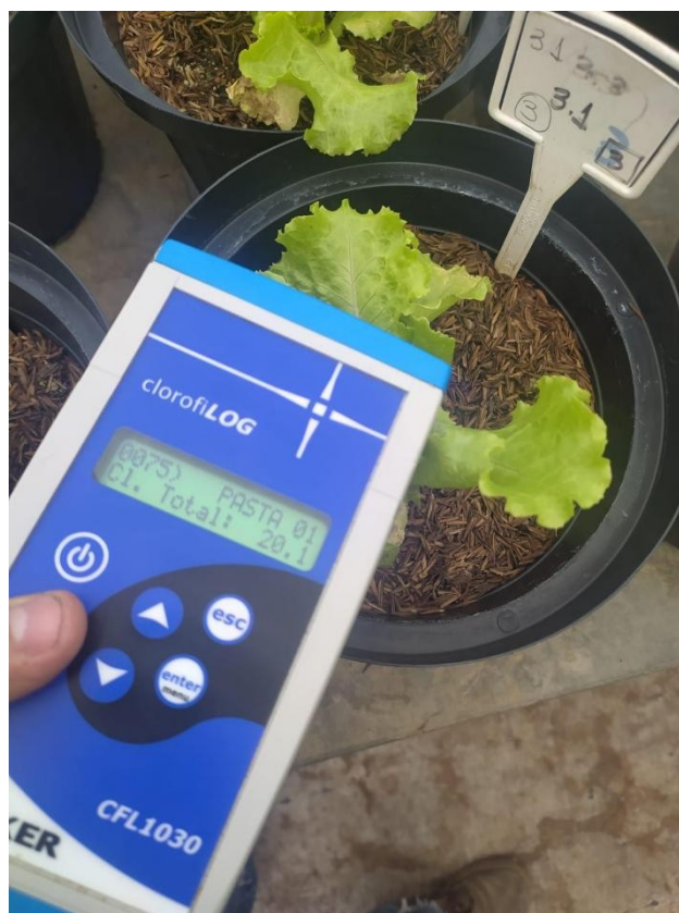
FIGURA 5: ANÁLISE DE CLOROFILA a, b E TOTAL DAS AMOSTRAS, UTILIZANDO O APARELHO PORTÁTIL clorofiLOG.
