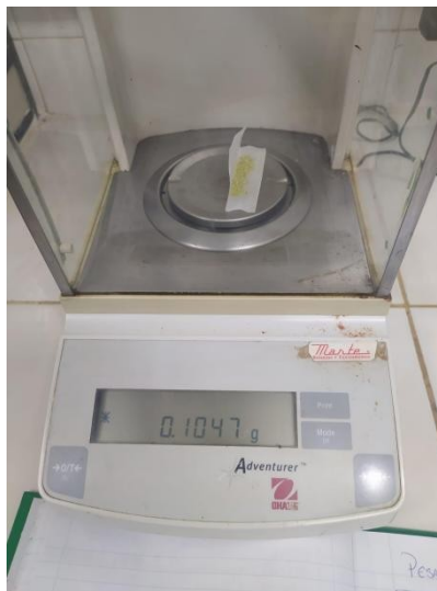
FIGURA 9: PREPARAÇÃO DAS AMOSTRAS PARA ANÁLISE DE NITROGÊNIO (N).
