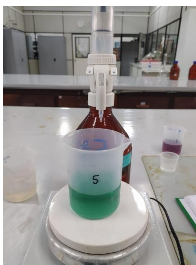
FIGURA 10: TITULAÇÃO DAS AMOSTRAS PARA ANÁLISE DE NITROGENIO (N) PELO MÉTODO DE Kjeldahl.
