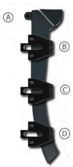
FIGURA 5- Diagrama dos componentes de leitura da bancada estática: A - tubo condutor; B – sensor óptico superior; C – sensor óptico intermediário e D - sensor óptico inferior;
