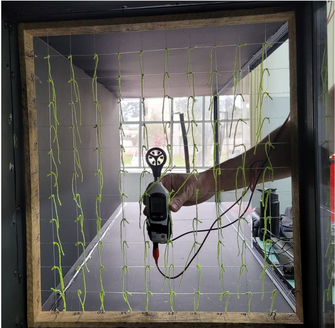
FIGURA 5: MEDIÇÃO VELOCIDADE DO VENTO PONTO X30Y30
