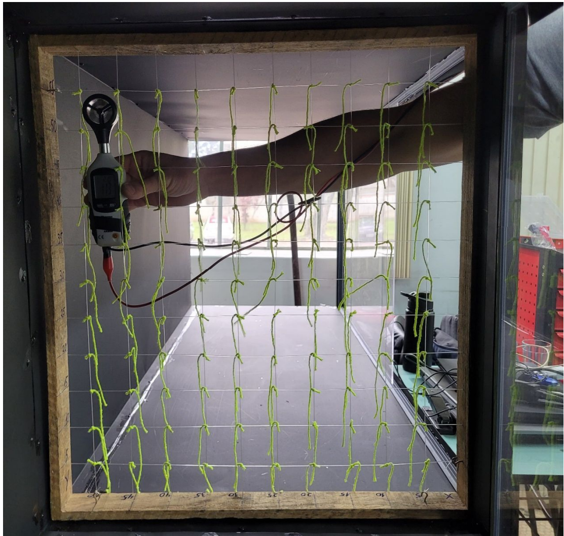
FIGURA 6: MEDIÇÃO VELOCIDADE DO VENTO PONTO X50Y55
