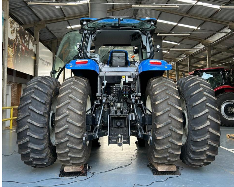
Figura 1 - Trator sendo pesado nas balanças do tipo sapata
