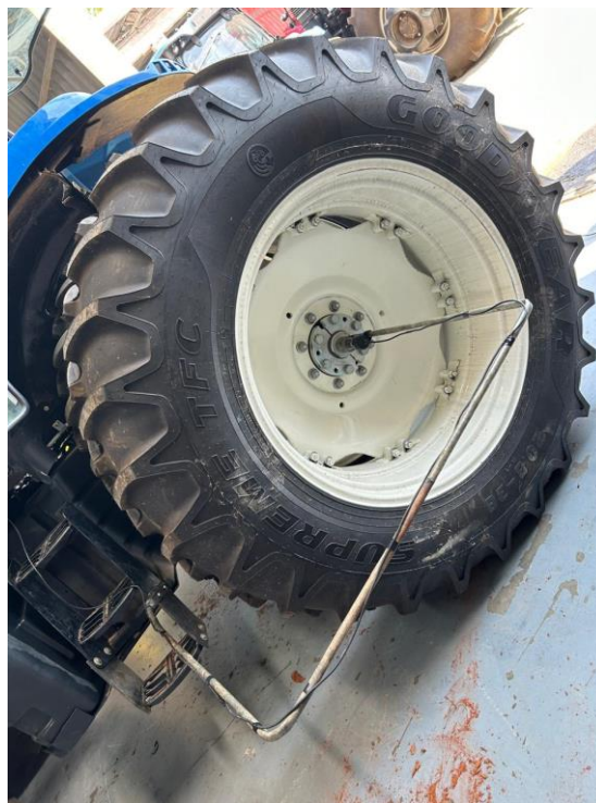
Figura 6 - Sensor encoder acoplado no trator
