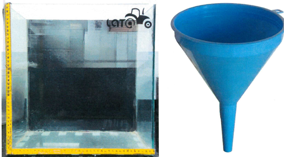
FIGURA 5: Recipiente de vidro e funil usados para mensurar ângulo de deposição.
