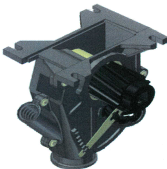
FIGURA 1: Dosador de sementes de fluxo contínuo com rotor acanalado helicoidal.
